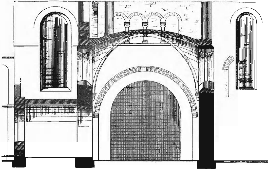
Fig. 53. Schnitt von Ost nach West durch den nördlichen Querarm. (Nach Innen gesehen. Massstab 1:150.)
