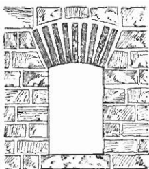
Fig. 72. Bogenöffnungen in der Südmauer der Sakristei. (Massstab 1:40.)
