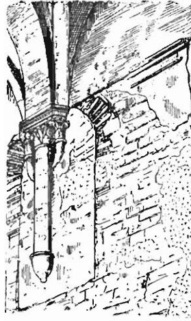
Fig. 68. Gurtbogenträger inmitten eines alten Fensters der südlichen Langhauswand.
