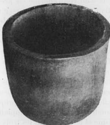
Fig. 26. — Emboutissage à froid en une seule passe d'une tôle de chaudière de 20 mm. d'épaisseur, découpée primitivement en un disque de 800 mm. de diamètre et rameulée finalement à un diamètre de 350 mm.
