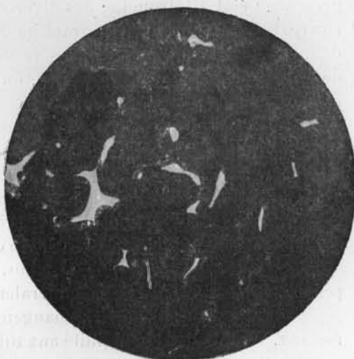
Fig. 31. Fonte grise avec eutectique phosphoreux en blanc.
