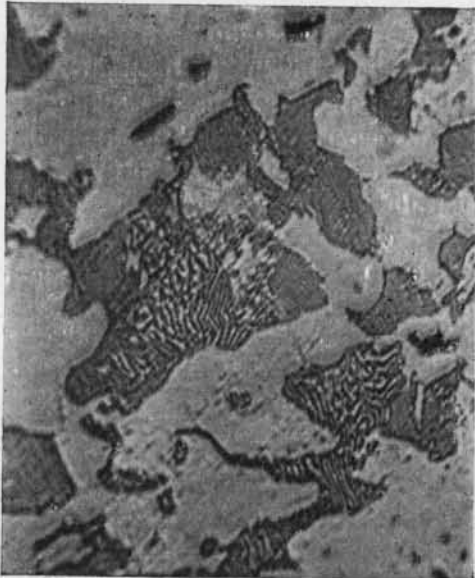
Fig. 15. Acier à 0,45 0/0 de C. Perlite partiellement dissociée. (Grossissement: 800 diam.).
