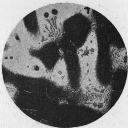
Fig. 32. Cuivre avec 0,5 0/0 d'arsenic et de l'oxygène.
