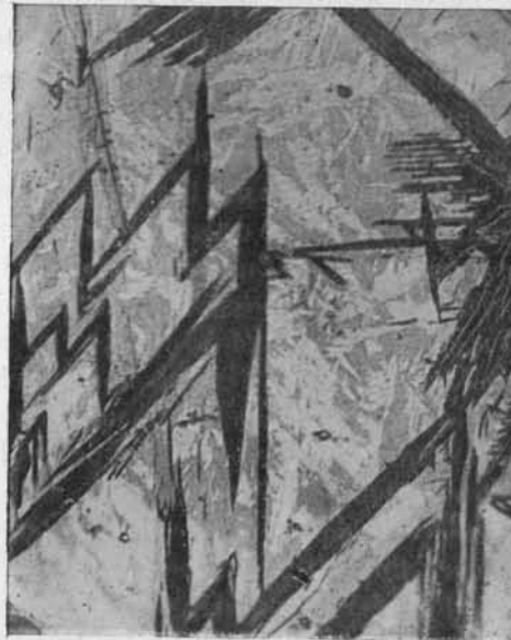
Fig. 37. Acier à 1,4 0/0 de C. trempé dans l'eau glacée à partir de 1.200° ( austénite en gris, martensite en blanc et osmondite en noir). Attaque moyenne.
