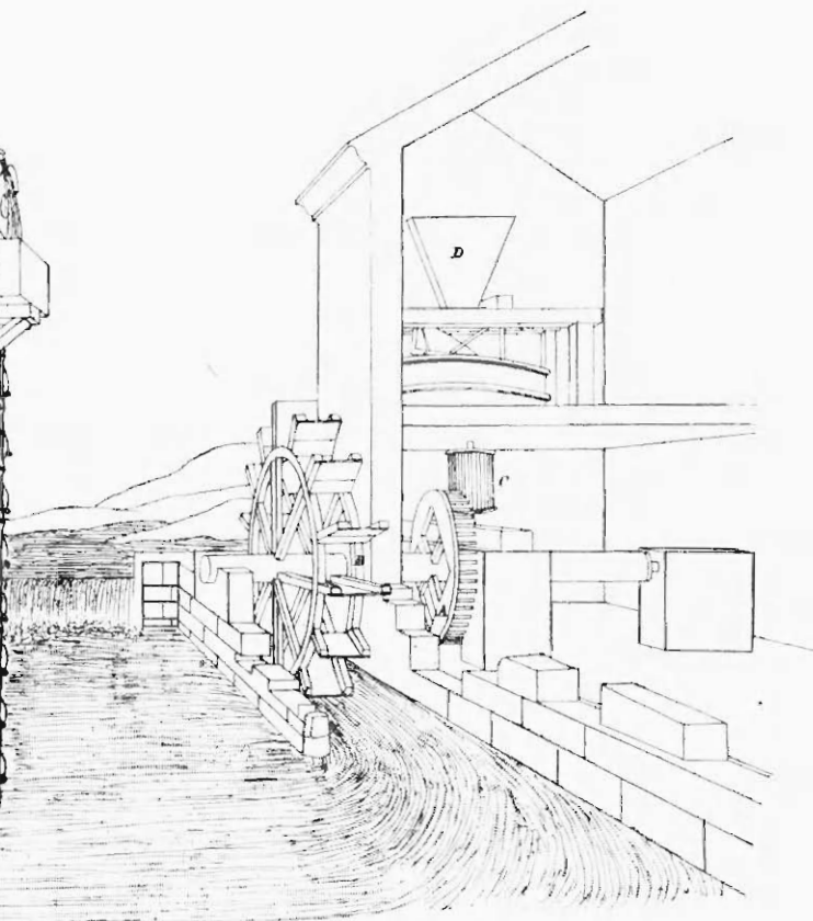
Fig. 24. — Roue hydraulique romaine. actionnant un moulin.
